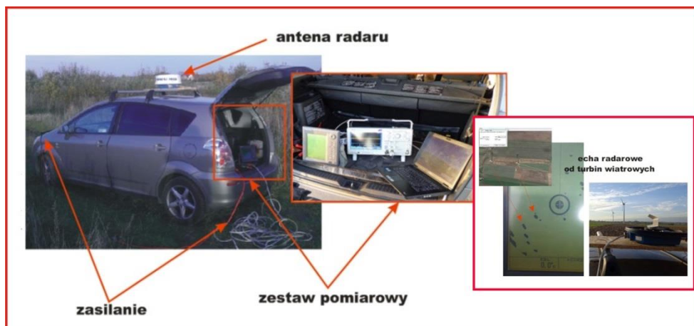
Rys 9. Przykładowe wykorzystanie mobilnego zestawu rejestracji obrazów radarowych do badania wpływu farm wiatrowych na działanie systemów radiolokacyjnych. (fot. M. Wąż). Opracowanie własne
