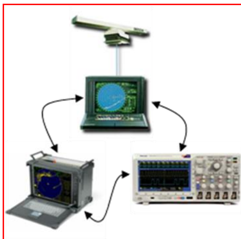
Rys. 3. Zestaw pomiarowy do rejestracji i analizy sygnałów radarowych (skład: Radar, PC z kartą Radar-Kit Maris5000, oscyloskop Tektronix DPO3012). Opracowanie własne.
