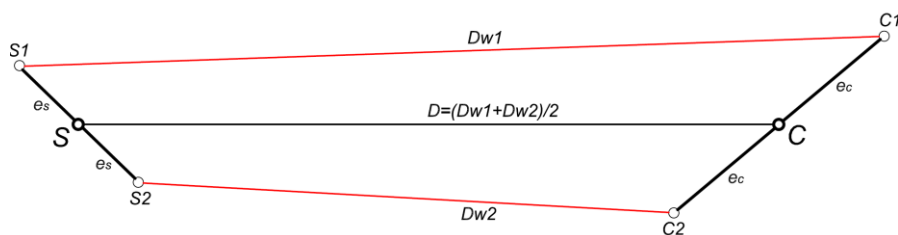
Rys.1.3. Metoda eliminacji niecentryczności anten stosowana na bazie Sveučilišta [4]
