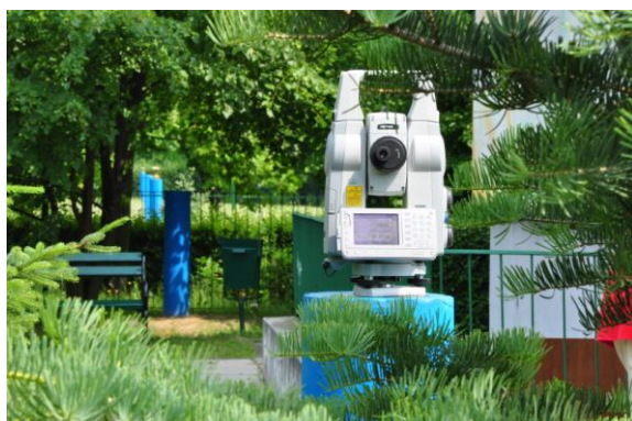
Rys. 2.8. Widok linii bazy i pomiar na stanowisku – tachimetr Sokkia Net05 – obsługuje T. Szczutko
