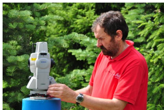
Rys. 2.8. Widok linii bazy i pomiar na stanowisku – tachimetr Sokkia Net05 – obsługuje T. Szczutko
