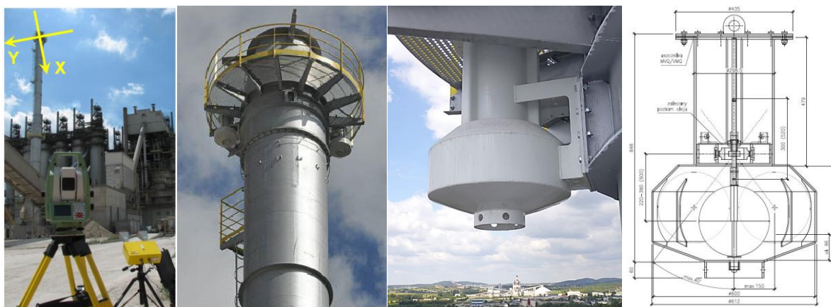
Rys. 42. Ustawienie instrumentów względem badanego komina, komin z zamontowanym tłumikiem oraz jego przekrój techniczny (źródło: publikacja nr 13)
