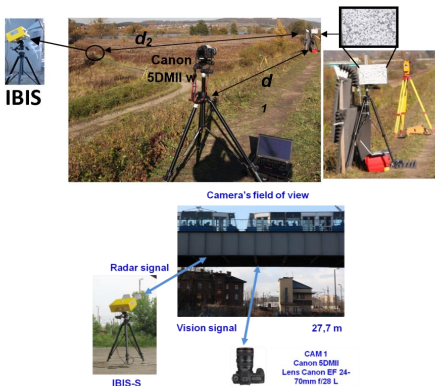
Rys. 30. Szkic relacji geometrycznych urządzeń w symulacyjnym (górny) i docelowym (dolny) teście terenowym (źródło: publikacja nr 9)
