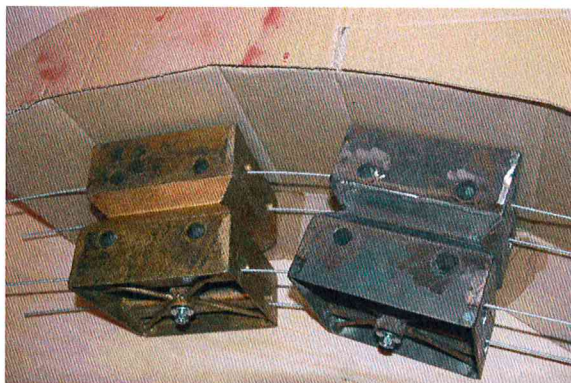
Wprowadzenie naprężonych cięgien w elementy składowe łuku powoduje, iż staje się on konstrukcją samonośną (makieta)
