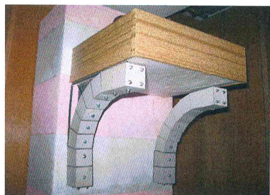
Wprowadzenie naprężonych cięgien w elementy składowe łuku powoduje, iż staje się on konstrukcją samonośną (makieta)
