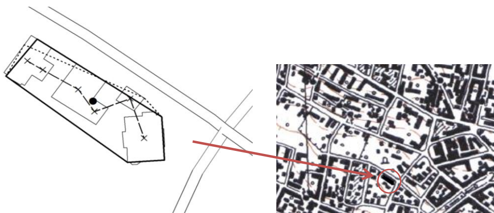
Rys. 11. Wyznaczenie obiektu DCM dla modelu DLM w skali 1 : 25 000: linia przerywana środki budynków oddalonych o wielkość określonych warunkiem bliskości, linia kropkowana to ośnowa kartograficzna wraz z wierzchołkami rozpoznawalnymi w zadanej skali, linia ciągła obiekt po zastosowaniu prostokątowania po prawej przygotowany obiekt nałożony na mapę w skali (źródło: własne)
