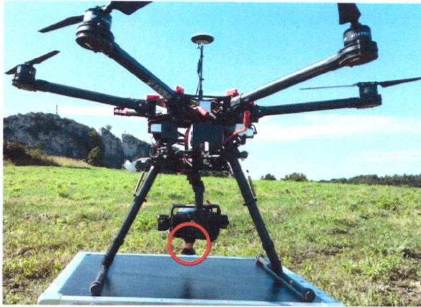
Rysunek 4.1. Sposób i miejsce montażu przyzmatu Mini360 na bezzałogowym statku latającym Źródło: publikacja [A2]
